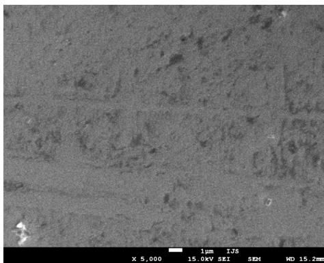
Figure 2: Microstructure of hardened DIN 1.7225 standard material (SEM) Slika 2: Mikrostruktura kaljenega materiala po DIN-standardu 1.7225 (SEM)
