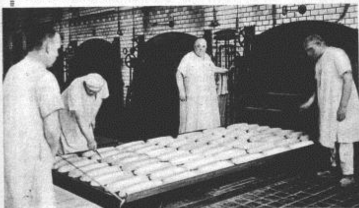
Auch im Bäckerei-Betrieb gibt es nur selten noch den Handbetrieb und den Einzelofen. Der Teig aus der Knetmaschine wird geschnitten, und Wagen bringen die geformten Brote zu den Öfen, die in großer Reihe nebeneinander stehen Presse-Photo
