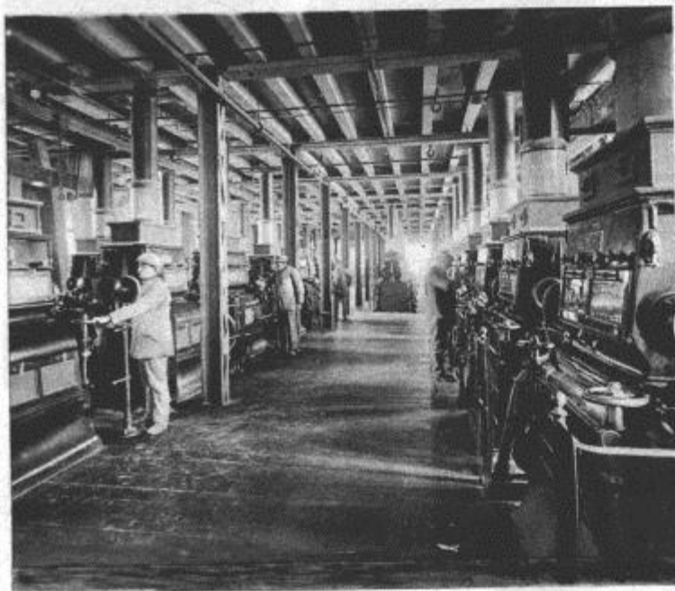
Mühlenromantik? Kein Mühlenflügel dreht sich mehr im Wind; das Geflapper der „Mühle am rauschenden Bach“ hat aufgehört. Sie sind beide nicht mehr „zeitgemäß“. Großbetriebe mit dampfenden Maschinen sind an ihre Stelle getreten, um den gesteigerten Bedarf schneller und rationeller zu befriedigen. — Blick auf den Walzenboden einer Großmühle mit umfangreichen Maschinenanlagen E.B.D.
