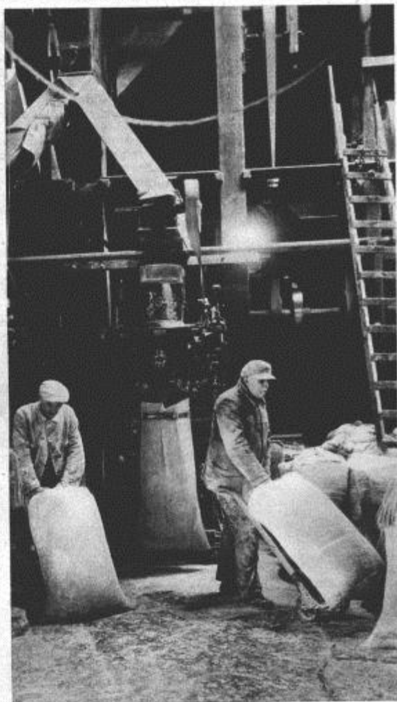
Die Mehlsäcke werden automatisch mit einer bestimmten Menge gefüllt und können in die Großbäckereien abtransportiert werden E.B.D.
