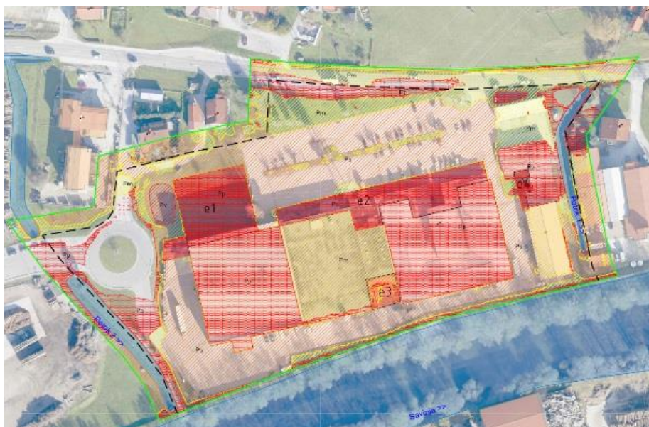
Prikaz razredov poplavne nevarnosti za predvideno stanje (Vir: Hidrološko hidravlična študija za spremembe in dopolnitve odloka o zazidalnem načrtu industrijsko – obrtne cone Prihova – Nazarje) (Provog d.o.o., št. proj. EL 23/29, julij 2023)
