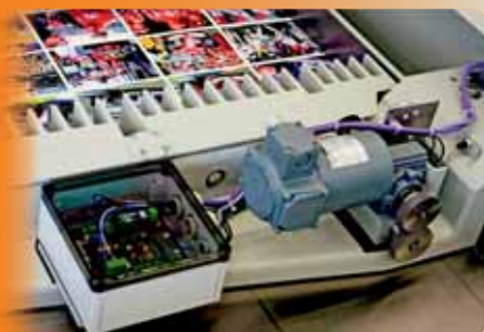
Prilagajanje naslonil Perfecte 92 TS glede na napake poševnega odtis.
