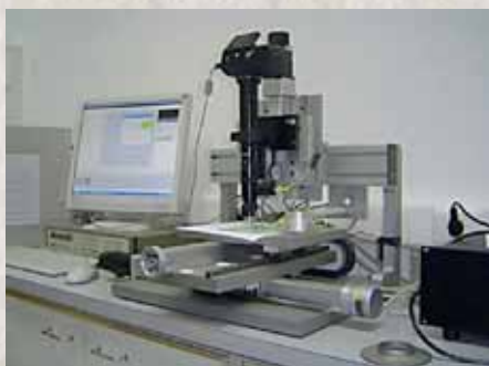
Slika 2: Topografska mizica skupaj z računalnikom, kamero in koračnimi motorji.
