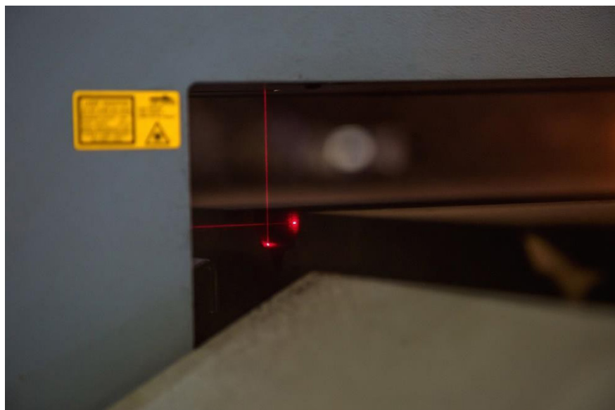
Slika 1: Sistem laserskega skeniranja zazna nedovoljena odstopanja pri formah pred litjem
