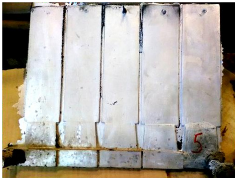
Slika 2. Deli za preizkušanje, izdelani iz zlitine AlSi10Mg, iz taline pri temperaturi 720 °C, ki so bili liti z dvema lijakoma
