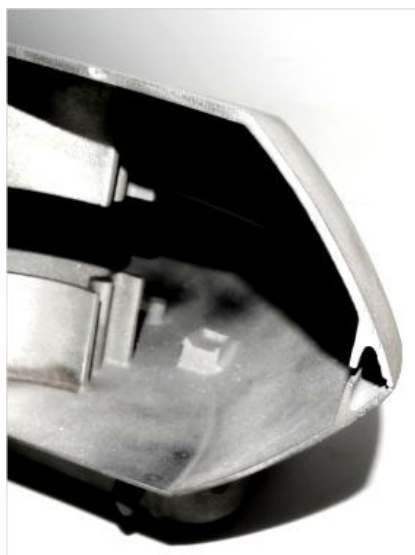
Slika 3. Testni gravitacijsko, v pesek liti kos za tlačno litje, zlitina: AlSi10Mg Geometrija: premera 540 mm, debelina stene zgornjega dela: 3 mm, spodnji del: 0,8–1,5 mm GTA14/5 DIN1688
