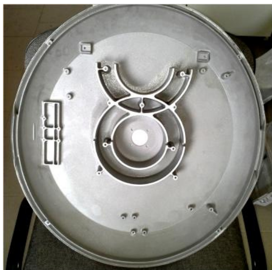
Slika 3. Testni gravitacijsko, v pesek liti kos za tlačno litje, zlitina: AlSi10Mg Geometrija: premera 540 mm, debelina stene zgornjega dela: 3 mm, spodnji del: 0,8–1,5 mm GTA14/5 DIN1688
