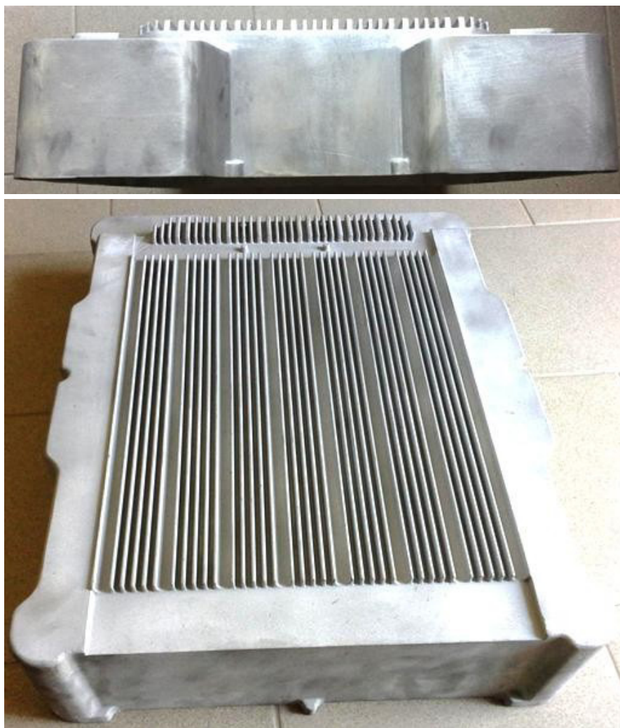
Slika 4. Serija prototipov z gravitacijskim litjem aluminija v pesek, zlitina: AlSi10Mg; Geometrija: 600 × 450 × 130 mm, debelina stene: 3,5 mm; GTA14/5 DIN1688
