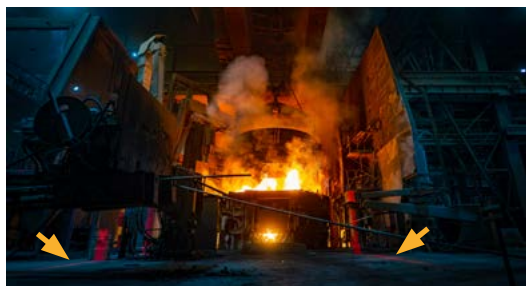
Žerjave smo opremili z varnostnimi LED lučmi, ki označujejo manipulacijski prostor žerjava.
