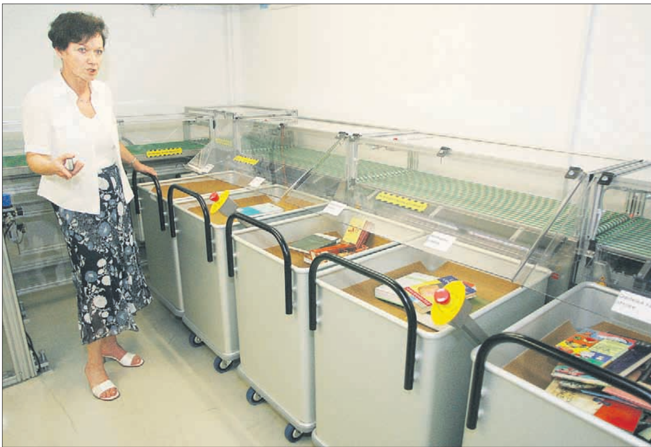
Ko tekoči trak pripelje vrnjene knjige v sortirnico, jih tam stroj avtomatsko razdeli v zaboje posameznih knjižničnih oddelkov.
