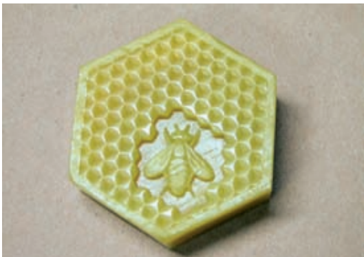
1. Pripravimo čist pozitiv iz voska, lesa, gline, mavca, plastike, stekla, kovine itd.
