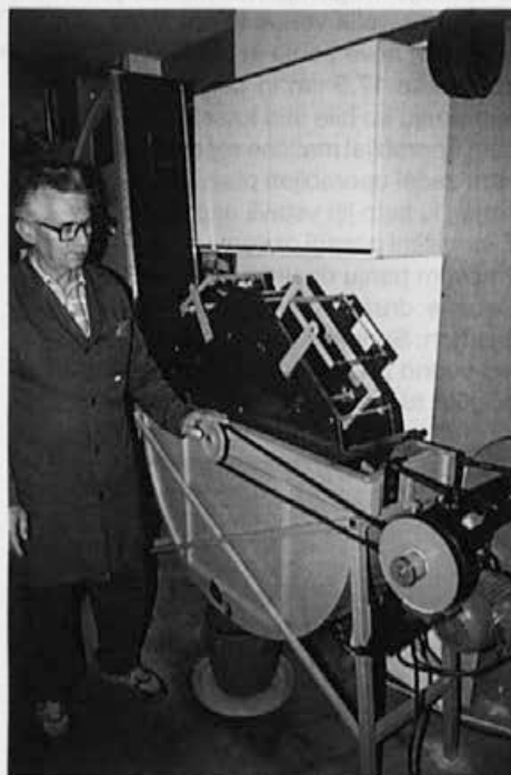
Točilo, ki si ga je čebelar Čuka izdelal sam. Foto: J. Mihelič
