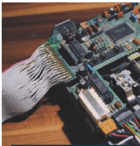
Prispajkani kabel na 5,25-palčni disketni pogon. Kabel je bil prvotno namenjen samo za priklop dveh 3,5-palčnih disketnih pogonov.
