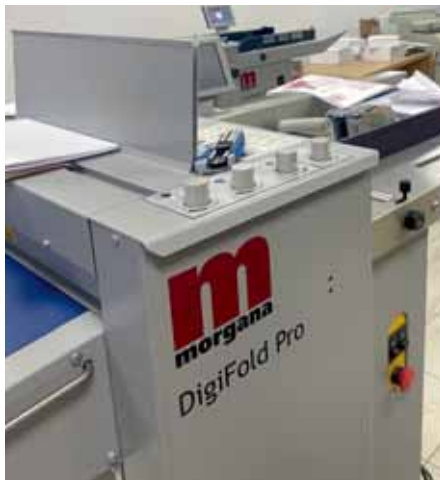
Med dodelavnimi možnostmi uporabljajo tudi rešitve znamke Morgana, ki omogočajo zgibanje, zlebljenje, perforiranje in rez v enem.
