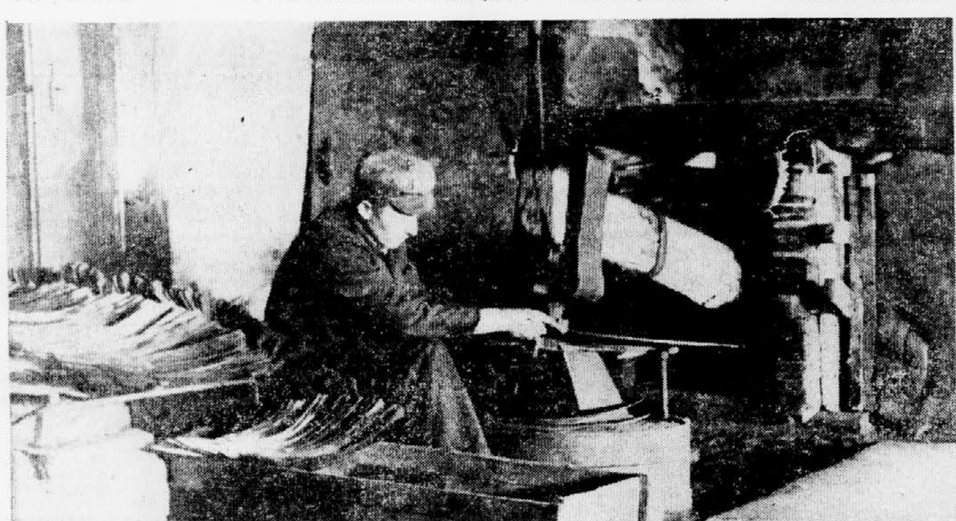
KLEPANJE KOS — Veliko kladivo vzdiguje vodno kolo, podobno mlinskim kolesom. Takšnih kladiv je v slovenjegraški tovarni kos največ. Na sliki: klepanje kos. V osmih urah jih delavce skleple približno 1200. Tri četrtine kos pa Slovenjgradčani prodajo v tujino po ugodnejših cenah, kot jih prodajo na domačem trgu.
