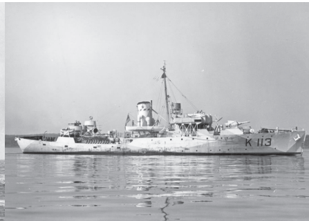
HMCS Arvida: enkrat z jamborom pred mostom, po predelavi pa za njim
