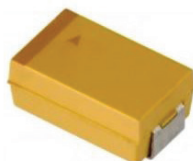
Tantalni kondenzator (SMD, črta označuje pozitivni priključek)
