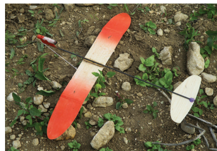
Zadnja leta v kategoriji S4A prevladujejo modeli z zlozljivim krilom, kot je ta na sliki.
