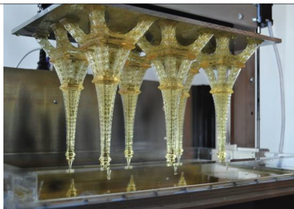
Slika 2. Osnovni princip gradnje izdelka s stereolitografijo (Kim et al., 2016 – levo) in primer tiskalnika z obrnjeno gradnjo izdelka – platforma se pomika iz bazena smole – desno (Large build volume Solidator ..., 2013)
