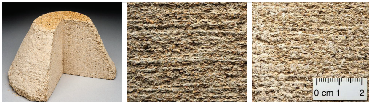
Slika 5. 3D-tiskanje z lesom s tehniko praškaste faze in brizganja veziva (Henke & Treml, 2013)
