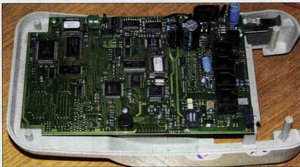
POS-terminal, v katerega vgrajena »skimming« naprava, omogoča dostop do bančnih podatkov imetnikov transakcijskih računov skupaj z varnostnimi PIN-kodami in magnetnimi zapisi.
