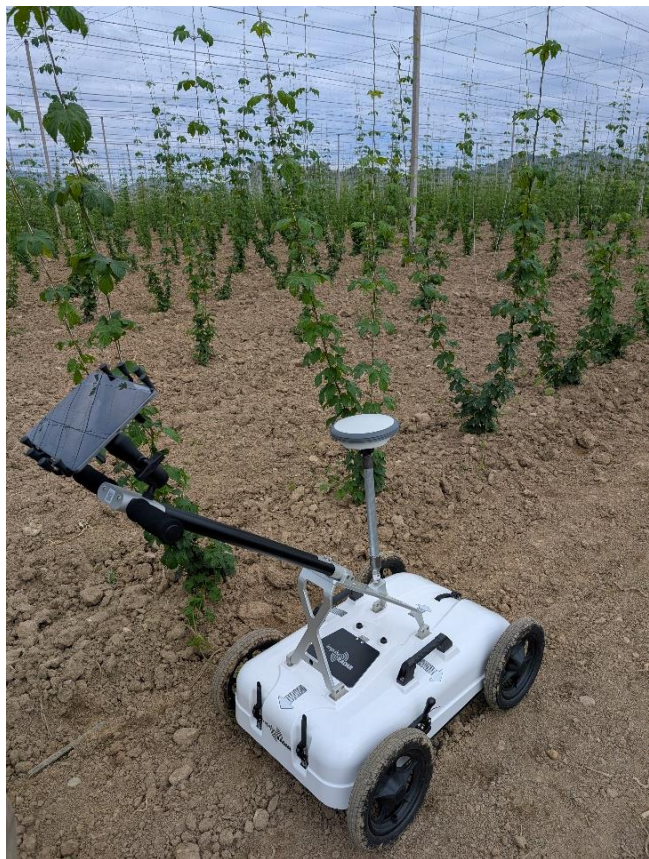
Slika 2: Georadarska naprava v hmeljišču (Foto: J. Ferlin)
