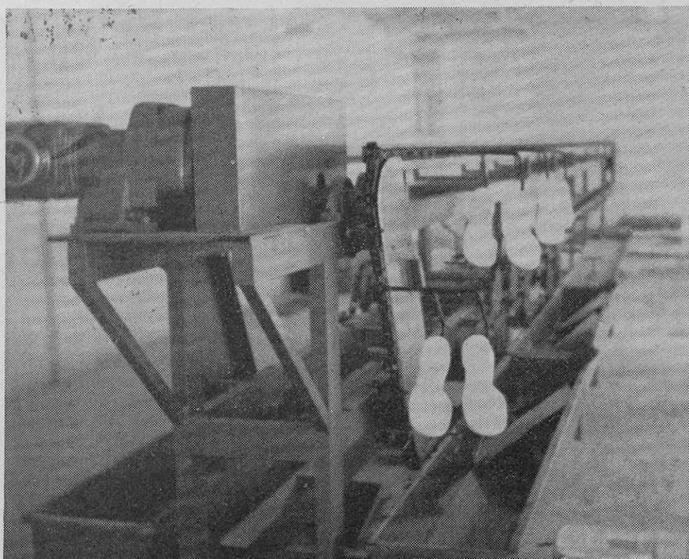
V hali za finišeiranje podplatov, je tudi stroj za potapljanje podplatov v barvo
