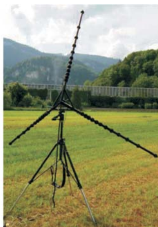
Slika 3: Različne mreže mikrofонов za uporabo: obroč za majhne razdalje in višje frekvenčno območje, križ za večje razdalje in nižje frekvenčno območje ter krogelna mreža za meritve v zaprtih prostorih
