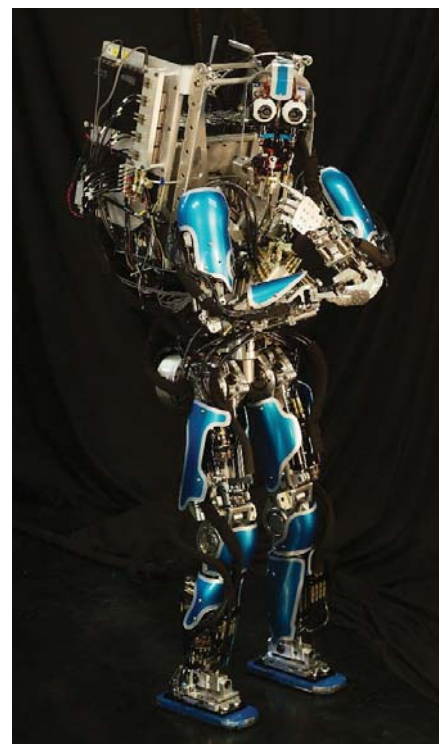
Slika 20. Humanoidni robot i-1 s hidravličnimi aktuatorji in vgrajenimi zaznavali momenta ima 50 prostostnih stopenj. Robot prepoznava zunanje sile in se aktivno upira neravnotežju. Pri močnem udarcu bo poskusil z nogami vzpostaviti ravnotežje, kot to počne boksar po močnem udarcu (ATR/JST/SARCOS/NiCT) [6].
