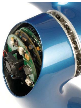
Slika 13. Podrobnost členka LWR III, kjer se vidita napajanje in druga elektronika za regulacijo in napajanje motorja.
