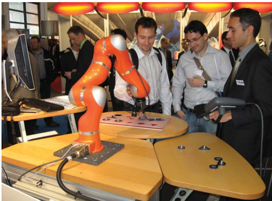
Slika 7. Robot, razvit v DLR, za trg izdeluje podjetje KUKA. Zaradi posebnosti izdelave je dražji od običajnega industrijskega robota.
