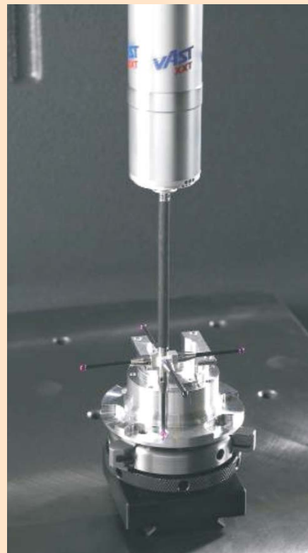
Merilna glava VAST XXT omogoča točkovno merjenje in skeniranje.
