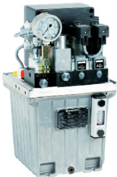
Vpenjalni agregat za delovanje z izklopi Po dosegu vpenjalnega tlaka se pogonski motor izklopi s tlačnim stikalom.
