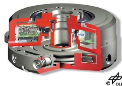
Slika 11. Zaznavalo momentov in sil, ki se uporablja v LWR III (Schunk)
