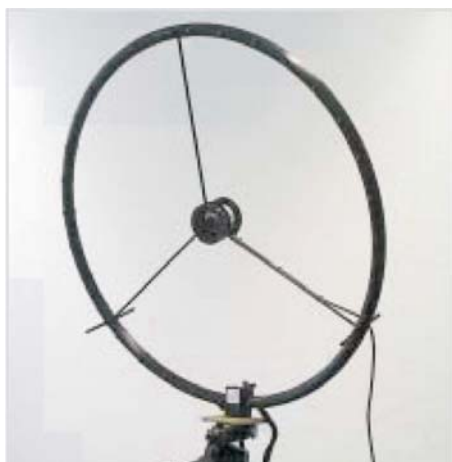
Slika 3: Različne mreže mikrofонов za uporabo: obroč za majhne razdalje in višje frekvenčno območje, križ za večje razdalje in nižje frekvenčno območje ter krogelna mreža za meritve v zaprtih prostorih
