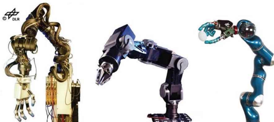
Slika 6. Razvoj robotske roke DLR LWR: izvirna izvedba DLR LWR s prsti DLR Hand 1 (1993), LWR II (2000) in LWR III (2002) z DLR Hand 2. LWR III je lahko roka iz ogljikovih vlaken, z maso 14 kg in nosilnostjo 14 kg v celotnem dinamičnem območju robota. Vse izvedbe imajo zaznavala momenta v vseh členih robotske roke [1].
