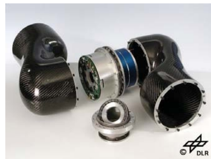
Slika 9. Razstavljen členek robotske roke LWR III, kjer je vidna kompozitna gradnja z vgrajenim motorjem, harmoničnim gonilom (harmonic drive) ter zaznavali momenta in položaja
