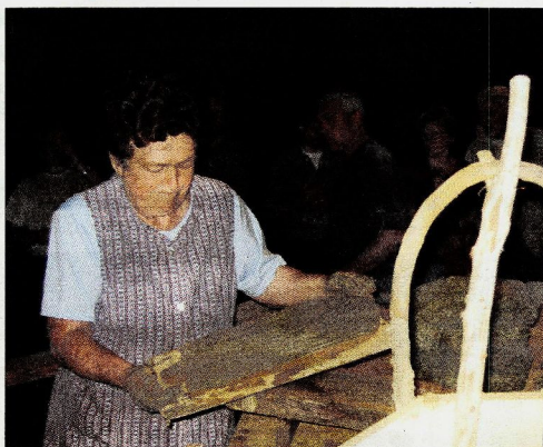
V »cigoncah« so vsi delali bosli. »Mort«, še posebej tistega za strešno opeko, se je velikokrat še z nogami premešalo, saj grudice, četudi majhne, niso bile dopustne. »Tale, ki je strojno premešan, ni pol tako dober, kot je bil naš«, ugotavlja Dragica Arčan.
