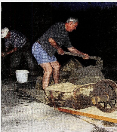
Material, iz katerega so narejene opeke, ni nič drugega kot zemlja, nakopana pozimi, ter vrčkrat (z motko in nogami) premešana z vodo. Za »bolj lušno delov« so »morti« naredili že prejšnji dan. Delavcem ga je tolkral vozil Dani Arčan.
