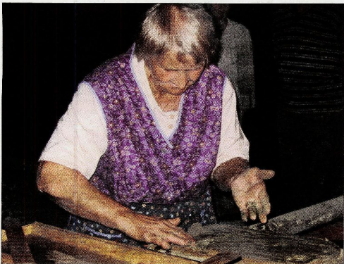
Prva je naredila strešno opeko, jo potresla s peskom, ki se je kapal okoli cerkve sv. Ane, da je imela opeka znamenito rdečo barvo, druga je opeki oblikovala kľun. V soboto se je s to ključno zadevo, od katere je odvisna stabilnost strohe, ubadala Marija Pangert.
