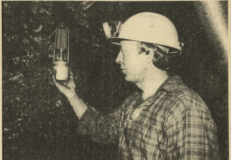
Rudar Jurij Fijačko ugotavlja metan z varnostno svetilko pred odstreilitvijo premoga v jami rudnika Trbovlje. (Foto: B. Klančar)
