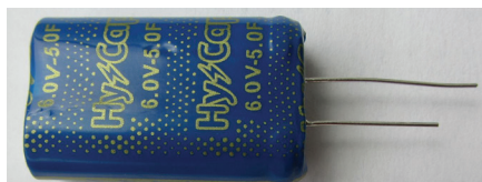
Polarizacijske oznake so izpisane na kondenzatorju.
