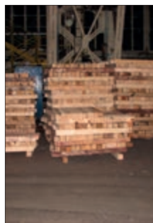
Zgledno pripravljene in zložene skladovnice podložnega lesa
