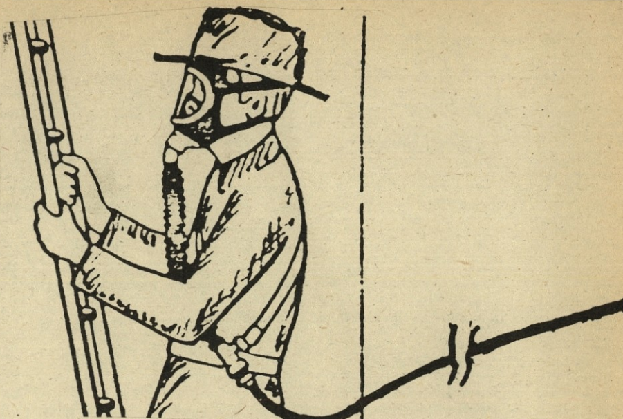
Cevni aparat z masko, za uporabo v rudarstvu
