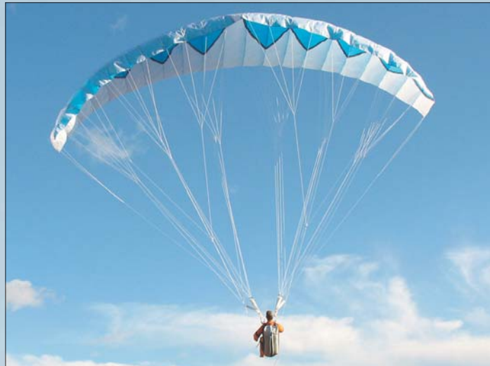
Slika 9. Med zaviranjem se lepo vidi navzdol zapognjen zadnji rob padala.
