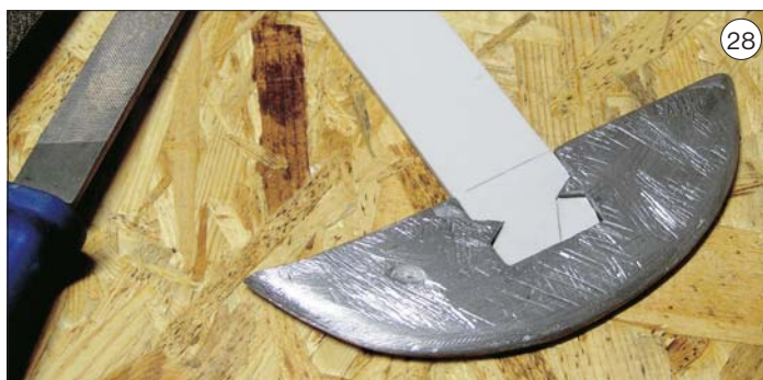
Oblika kalupa iz 5 mm debele vezane plošče za izdelavo svinčene obtežitve (merilo: 1 : 1)
