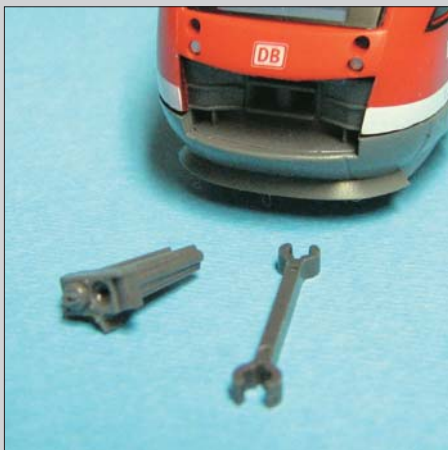
Model je opremljen za samostojno vožnjo (leva spenjača) ali spajanje motornih vlakov (desna spenjača).
