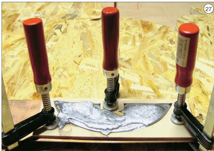
Oblika kalupa iz 5 mm debele vezane plošče za izdelavo svinčene obtežitve (merilo: 1 : 1)
