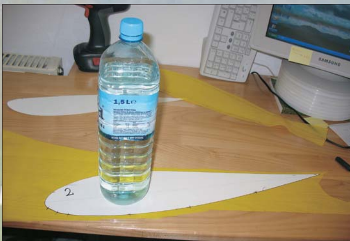
Slika 2. Pri zarisovanju ob šablono označimo sprednje odprtine in točke vpetja vrvic. Da se šablona ne premika, si pomagamo kar s steklenico vode.
