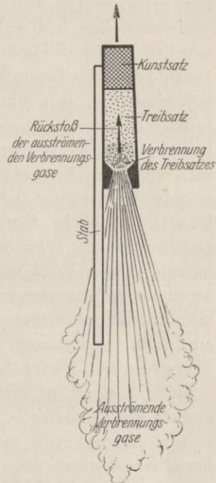
Abb. 15. Feuerwerkkrakete im Längsschnitt. Der daran befestigte Stab dient dazu, das Sichüberschlagen der Rakete zu verhindern.
