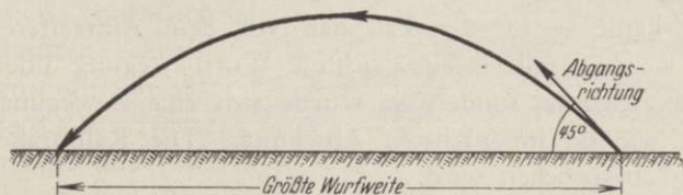
Abb. 47. Mit einer gegebenen Abgangsgeschwindigkeit wird dann die größte Wurfweite erzielt, wenn der Abgangswinkel 45^\circ beträgt.
