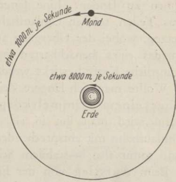
Abb. 7. Die Umlaufgeschwindigkeit ist um so größer, je näher zum Anziehungszentrum die freie Umlaufbewegung erfolgt.
