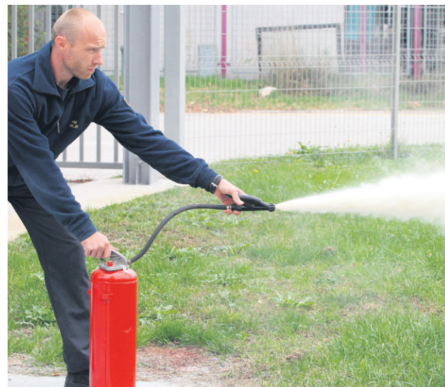
Gasilni aparat je pripravljen za gašenje. Pritisnemo na vzvod ročnika, curek gasilnega prahu usmerimo v gorečo površino in ročnik pomikamo levo in desno. (Slika je simbolična.) Novejši gasilniki so pod stalnim tlakom in brez ročnika, tako da pri odstranitvi varovalke samo stisnemo ročico in so že aktivirani. Takšne gasilne aparate spoznamo po manometru, ki je nameščen ob ročici.
