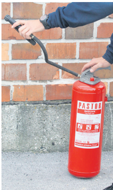
Ko je varovalka izvlečena, pritisnemo ročaj sprožilnega mehanizma gasilnega aparata.
