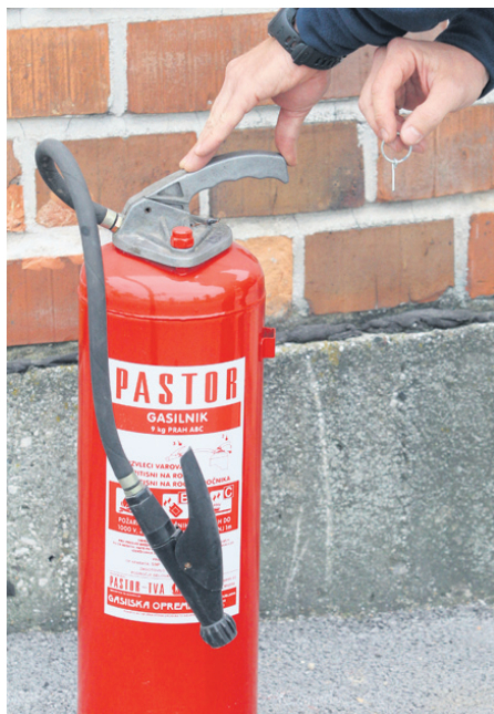
Zatem ko gasilnik vzamemo s stojala na zidu, sprostimo gumijasto cev in šele nato izvlečemo varovalko, ki je nameščena pod ročajem.
