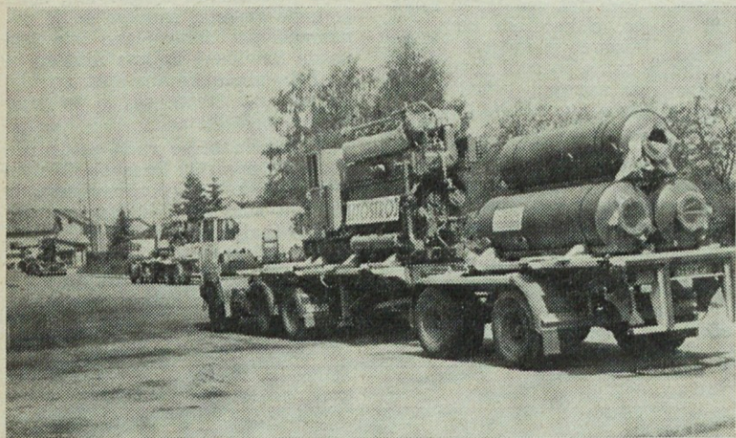
Konec maja smo iz Litostroja poslali Dieselske motorje tip 6T 23 HH v ladjedelnico »3. maj« na Reki. Vsak motor ima 720 KM, teža pa znaša 12 ton.
