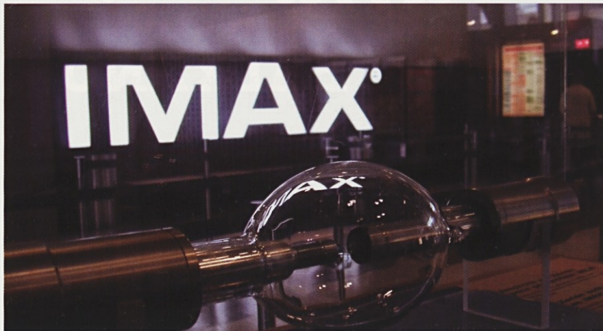
15kW Xenonova žarnica za IMAX GT-projektor
