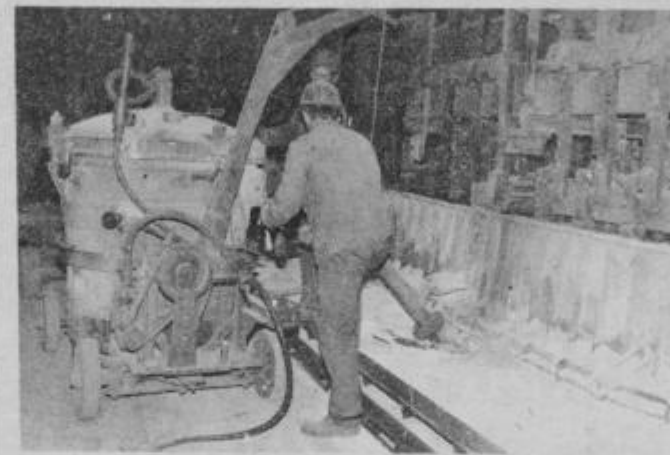
V sedanjih elektrolizah — hali A so pogoji dela najtežji. Na posnetku: vakuumsko črpanje tekočega aluminija.
