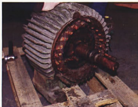
Slika 2. a) Fotografija 3kW asinhronskega motorja pred obnovo in b) fotografija motorja med previjanjem.
