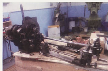
Slika 3. a) Fotografija stroja za palične sponke pred obnovo in b) fotografija glave stroja z dodanimi zobniškimi dvojicami, ročico sklopke, nabiralno letvijo in mehanskim odrezom paketa sponk.
