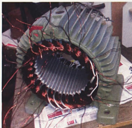
Slika 2. a) Fotografija 3kW asinhronskega motorja pred obnovo in b) fotografija motorja med previjanjem.
