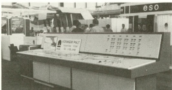
Komandni pult z logičnim procesorjem
