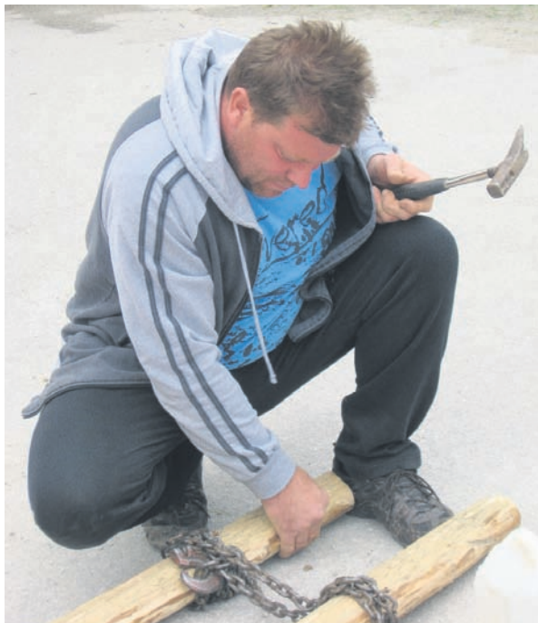
Brez tega pripomočka ni ročnega postavljanja mlaja. Tako imenovane »žavre«, dva drogov, ki sta na vrhu povezana z verigo.
