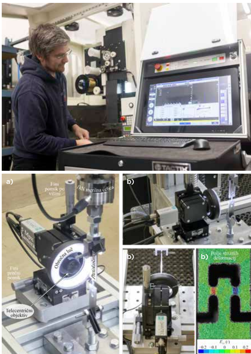
Slika 2 : Zgoraj: Mikro elektroerozijski obdelovalni sistem MAKINO U3; spodaj: a) Makino U3 je kompaktna visoko precizna mikroelektroerozijska naprava, namenjena izdelavi kovinskih preizkušancev z izjemno majhnimi tolerancami in kompleksnimi geometrijami; b) koncept preizkušanja MT2.0. (Foto: Laboratorij LNMS)
