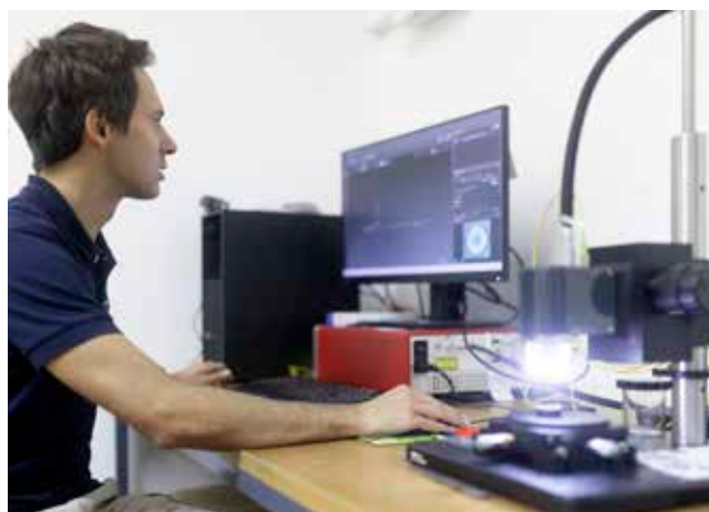
Slika 1 : Merilni sistem za sprotni nadzor topografije med laserskim procesiranjem – nova perspektiva nadzora (Foto: Laboratorij LASTEH)
