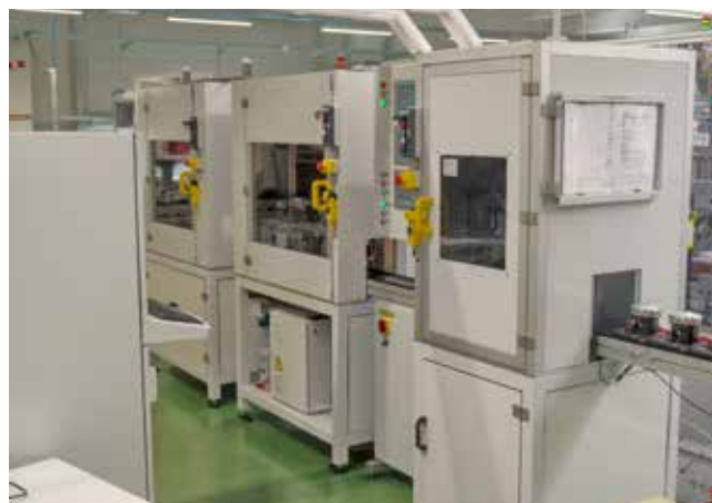
Slika 1 : Primer modularnega EoL diagnostičnega sistema
