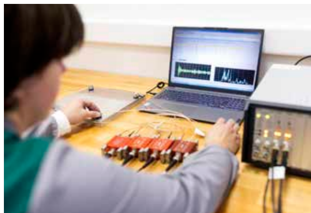
Slika 4 : Večkanalni sistem Vallen AMSY-6 v LATOP omogoča zajem signalov akustične emisije, lokalizacijo izvora v 3D-prostoru ter spremljanje nastanka in rasti poškodb v realnem času.
