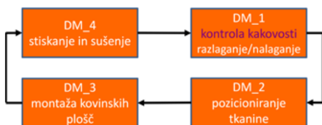
Slika 2 : Logična shema procesa montaže za Primer iz prakse 1
