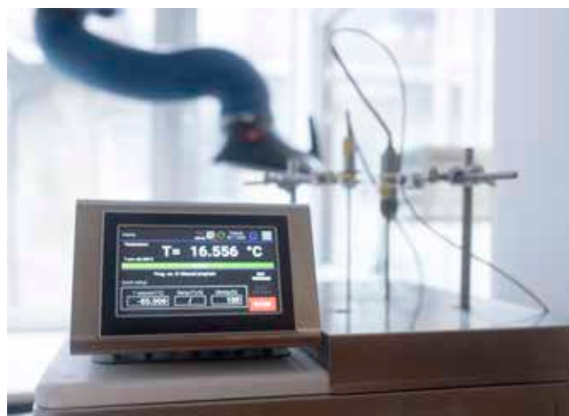
Slika 3 : Oprema omogoča homogena in stabilna temperaturna polja pri ultranizkih temperaturah, kar odpira različne možnosti uporabe pri znanstveno-raziskovalnem in razvojnem delu laboratorija. (Foto: Laboratorij LMPS)
