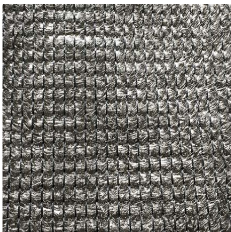
Slika 14: Netkana tekstilija Maliwatt iz recikliranih ogljikovih vlaken [12]
