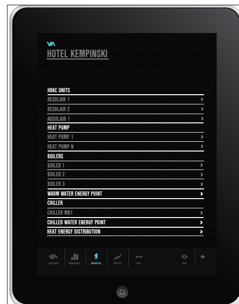
Pregled energetike – v tem pogledu je mogoče nadzorovati celotno energetiko zgradbe – od ogrevanja, hlajenja pa vse do prezračevanja in klimatizacije.
