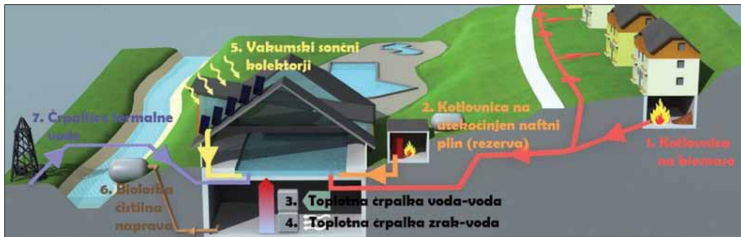
Shema naprav za učinkovito rabo energije v Termah Snovik
