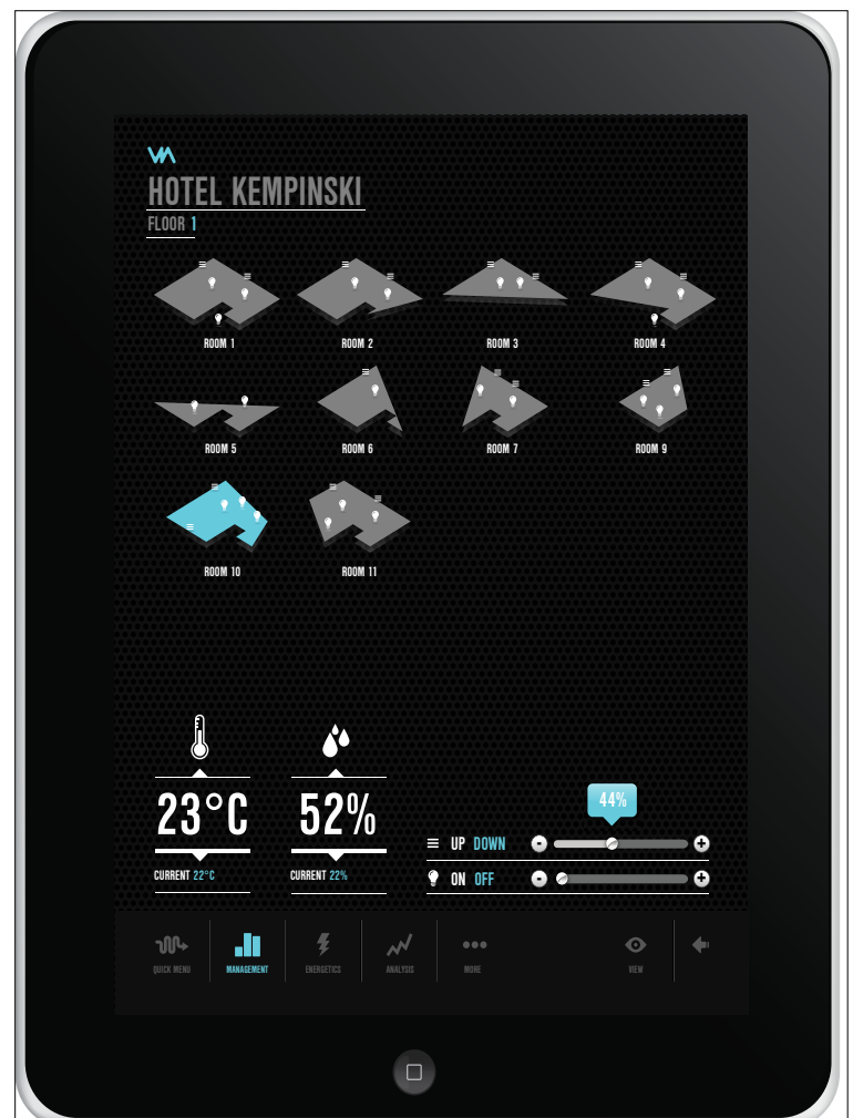
Primer sob v prvem nadstropju hotela. Od tukaj lahko nadziramo in upravljamo razsvetljavo, žaluzije, temperaturo in vlago v celotnem nadstropju ali se premaknemo globlje v posamezno sobo.
