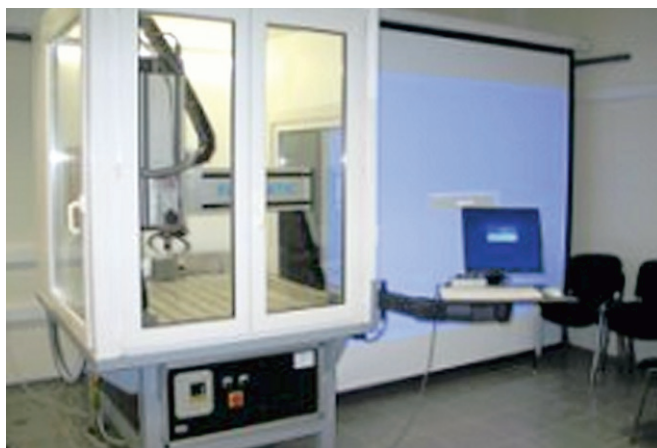
Hitrofrezalni stroj za mehke materiale (hitra izdelava prototipov)
