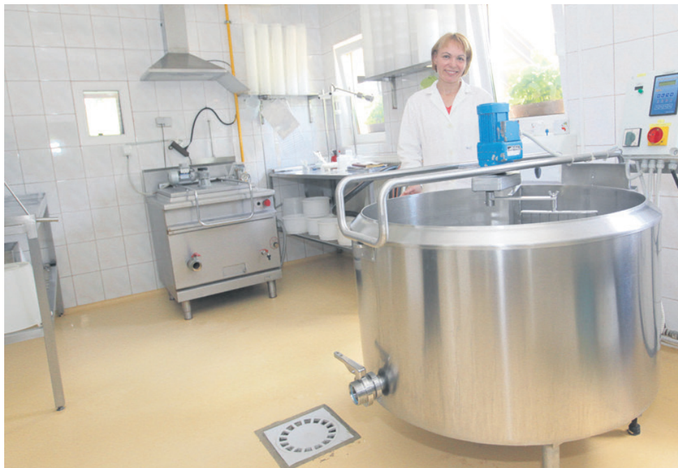
Mleko po ceveh priteče v bazen, kjer je glavni tehnološki postopek sirjenja. Sonja iz bazena pobere sirnino in odstrani sirotko. Dobljeno maso nato postavi v stiskalnico. Ko se sirnina stisne, potuje masa v prostor s slanico. Sir dozori v zorilnici.
