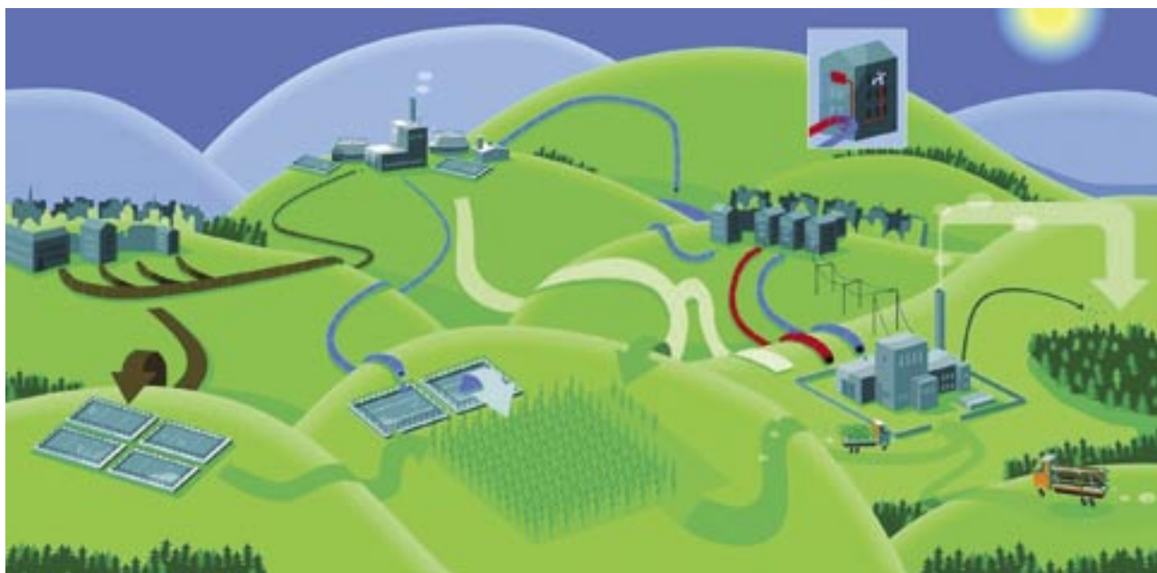
Slika 2: Kako deluje: daljinsko ogrevanje in pridobivanje električne energije z uporabo biomase pridobljene iz lesnih odpadkov in nasadov z energetskim lesom ob uporabi odpadnih hranilnih virov v zaključenem masnem toku (shema: Arhiv ENA Energi AB).
