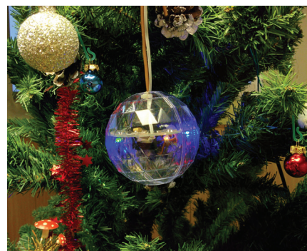
Za gibanje okraska skrbi servomehanizem, za svetlobne učinke pa raznobarvne svetlobne diode.
