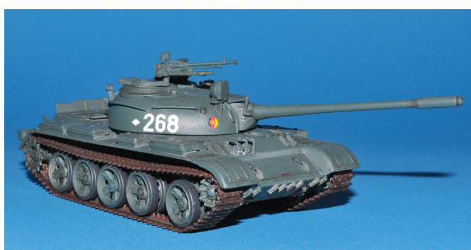
Revellova ponazoritev podpornih koles s precej grobo ponazoritvijo ostankov vulkanizacije gumijastih obročev
