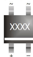
Priključki diodnega mostička S40
