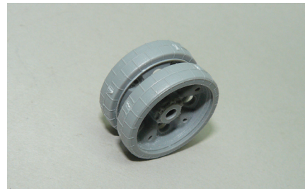
Sestavljeno kolo pred obdelavo gumijaste obloge
