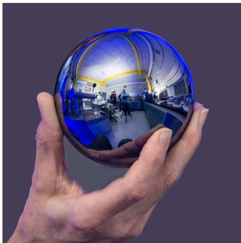
Slika 10. Silicijeva krogla, s katero določijo enoto za množino snovi mol. Vir: NIST
