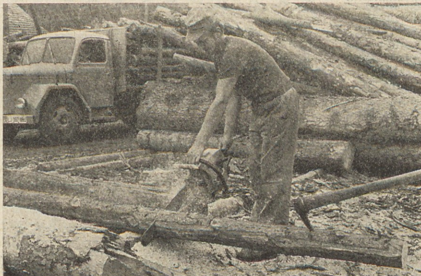
Jože Novak z ročno motorno žago prirezuje jamski les, ki ga pripravlja za vse TOZD proizvodnje premoga — TOZD Predelava jamskega lesa Trbovlje. (Foto A. Bregant)
