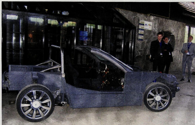
Na Rogli so veliko pozornosti vzbudili tudi študenti s svojim prototipnim vozilom. Vsi deli, razen mehanske osnove, so izdelani na fakulteti. Ko bo dobil še končno obliko športnega avtomobila, bo služil za testiranje prototipnih režimov, ki jih bodo razvili na fakulteti ali v podjetjih.
