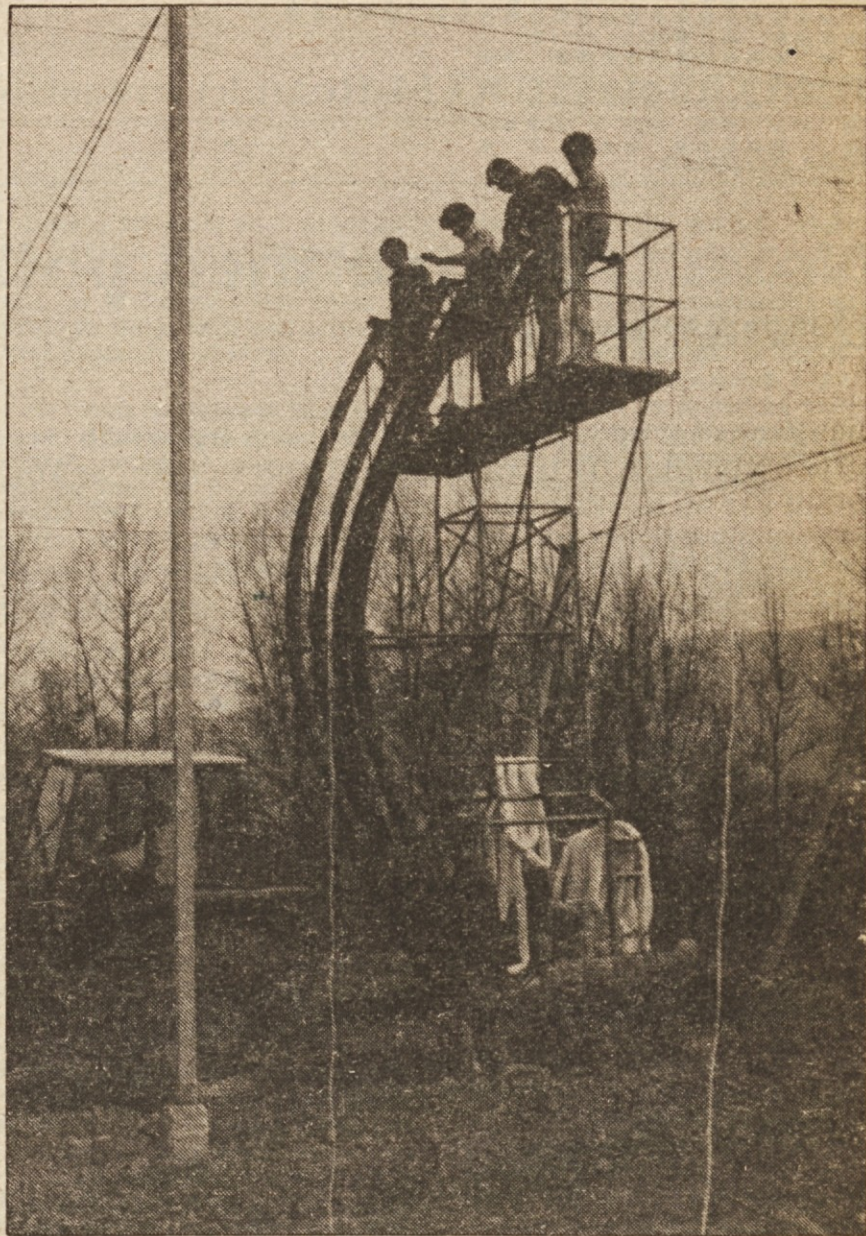
Stolp za obešanje vrvic se sedaj od traktorja lahko odklopi, zamenjava snopov vrvic je enostavna in hitra.
