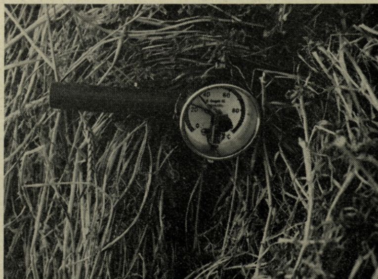
Na velikih dosuševalnih napravah po naših farmah uporabljajo kontaktne toplomere s sondo, ki ob dvigu toplote v notranjosti kupa do določene toplote sami vklopljajo ventilator
