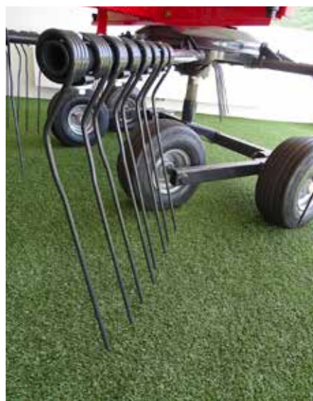
Upognjeni vzmetni prsti pri SIP-ovem zgrabljalniku STAR.
