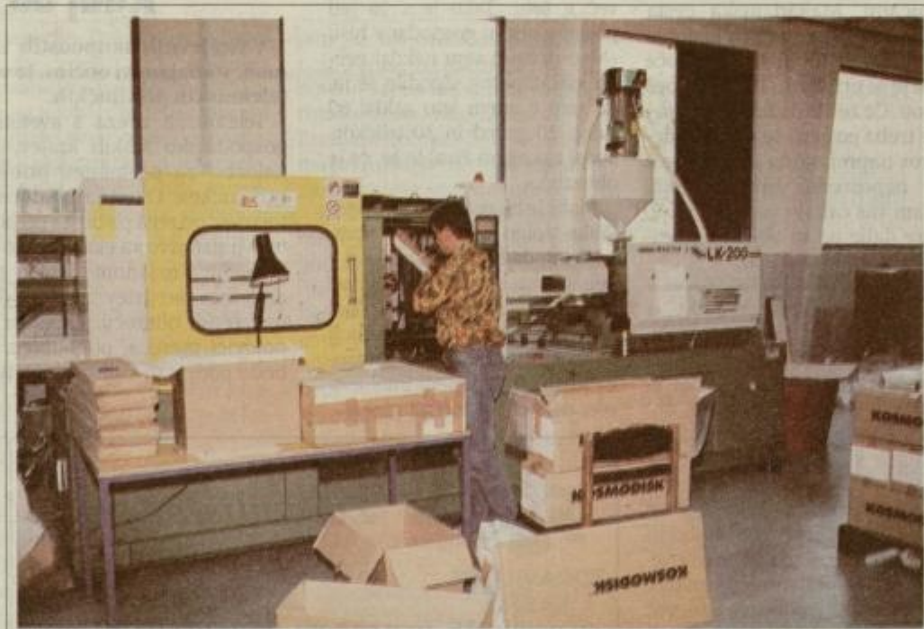
V podjetju Europolimer stoji nov stroj za injekcijsko brizganje, ki ga med drugim uporabljajo za izdelavo kosmodiska, uspešnega proizvoda Studia Moderna iz Zagorja.
