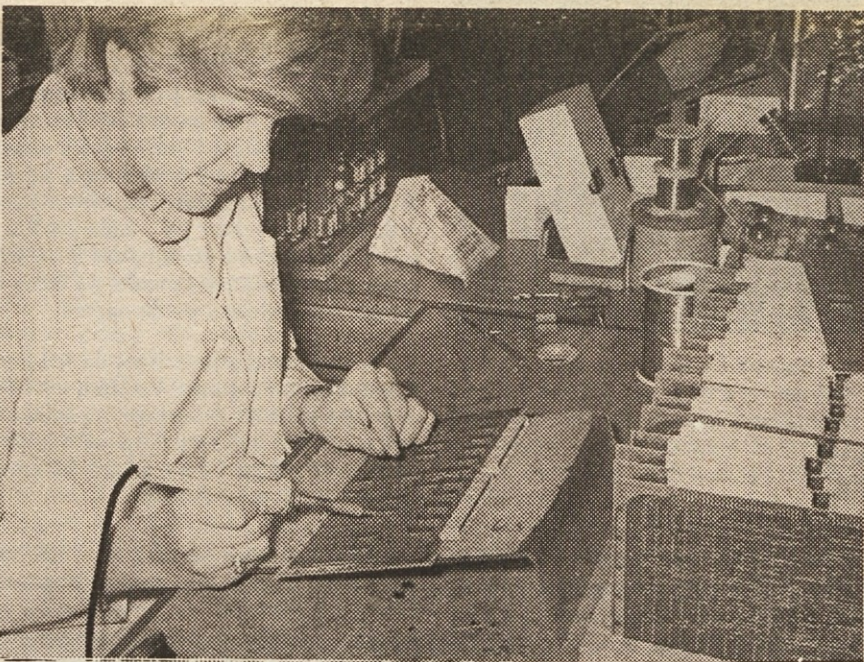
Vstavljanje in spajkanje komponent v vtične enote računalniške opreme.
