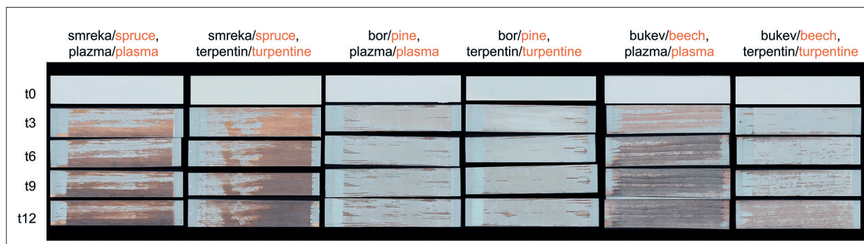
Slika 4. Sistem premaza proti obraščanju (HR), brez temeljnega premaza, med enoletno zunanjo izpostavitvijo.
