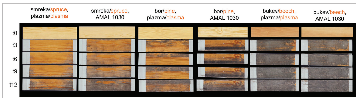
Slika 3. Sistem alkidnega prozornega premaza (AMAL) med enoletno zunanjo izpostavitvijo.
