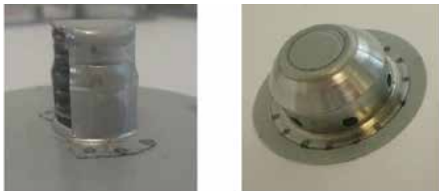
Slika 3 : Ohišje, ukrivljeno iz kosa pločevine (levo: \Phi 97 mm x 40 mm), in pasarsko ohišje (desno: \Phi 97 mm x 35 mm)
