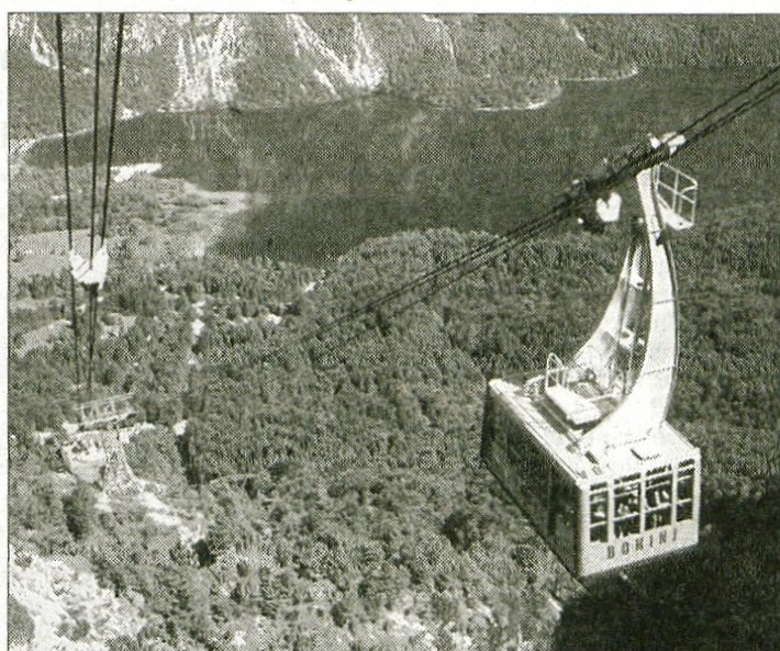
Posebnost nove nihanke je v veliki strmini vzpona, ki je kar 70-odstoten, s tem se uvršča med najbolj strme žičniške trase v Evropi.
